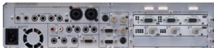
Connettori del pannello posteriore dell'AWS-G500HD
