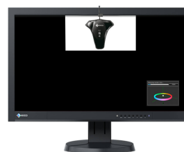
Rilevamento del punto di bianco e dei valori del punto di bianco con sensore di calibrazione esterno
