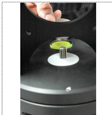
5. Teflon Beilagscheibe aufsetzen / Put small tefflon disc on M12 screw
