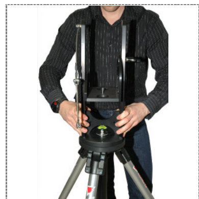
9. Kranstütze sollte noch frei beweglich sein / Column should move still free
