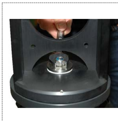
8. M12 Mutter festziehen, Friktion einstellen / Fix screw nut - setting friction of pan axis
