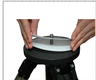
3. 2 Teflonscheiben auflegen / Assembling of two tefflon-coated discs
