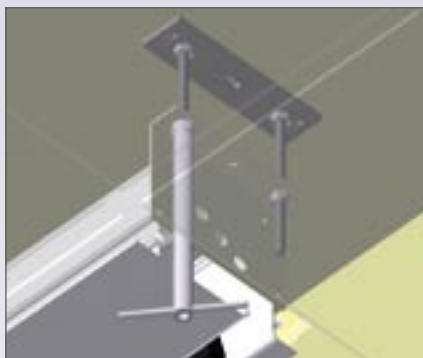
Con le chiavi a tubo si porta il bordo inferiore rasente al controsoffitto.
