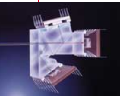
Il nuovo CCD 1/3" ad alta sensibilità garantisce 625 linee di risoluzione orizzontale.
