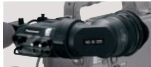
AJ-VF20WB 2" EVF 16:9/4:3 switchable
