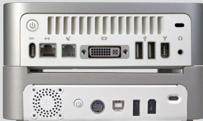
Vista posteriore di un'unità Mac mini impilata su un'unità LaCie mini Hard Drive & HUB (l'unità Mac mini deve essere acquistata a parte)
